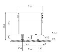
Electrical inlet (power) Equipotential screw
